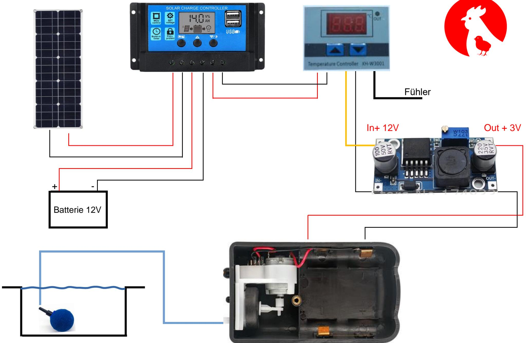
Schaltplan Tränkensprudler Umbau mit Solarpanel und Temperatursteuerung 12V => 3V
